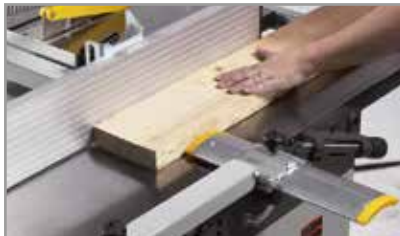
Aluminium parallel guide for upper table works Guía paralela de aluminio para los trabajos de mesa superior
