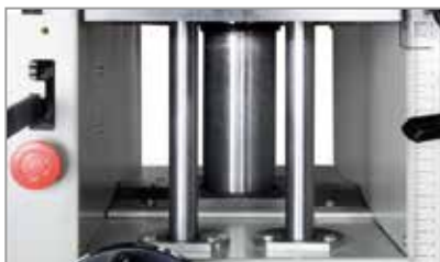
Planner and thicknesser working table mounted on 3 guides in order to avoid the plan rotation Mesa de trabajo montada sobre tres guías de soporte para evitar la rotación del plan
