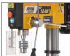
Chuck protection Protección del portabrocas
