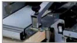
Thicknessing operation (l=154 mm - h 100 mm) Operación de reguesado (l=154 mm - h=100 mm)
