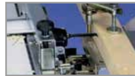
Morticer with sliding carriage Fresadora con carro deslizante
