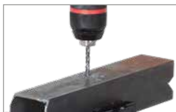
Drilling speed steel: 170-880 min -1 Velocidad de taladro acero: 170-880 min -1
